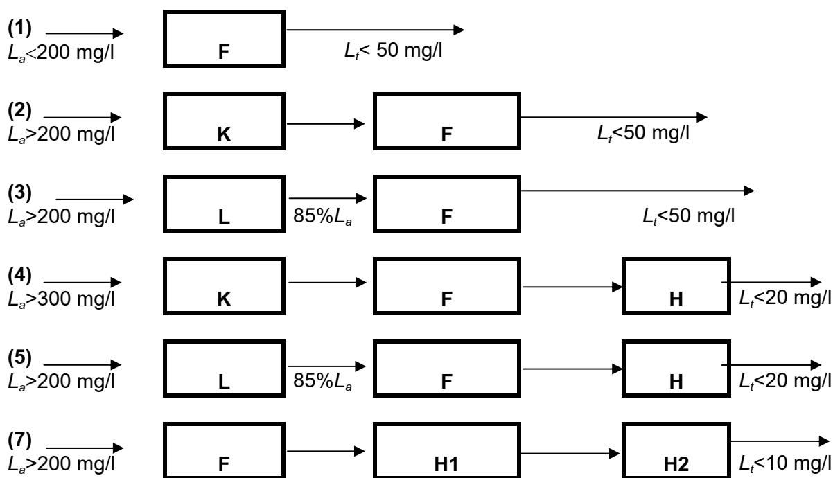
CHÚ THÍCH: F-hồ tùy tiện; K- hồ kỵ khí; H- hồ hiếu khí; H1- hồ hiếu khí bậc một; H2- hồ hiếu khí bậc hai; L- hồ lắng;  $L_a$ -BOD của nước thải chưa xử lý;  $L_t$ - BOD của nước thải sau xử lý trong hệ thống hồ.
